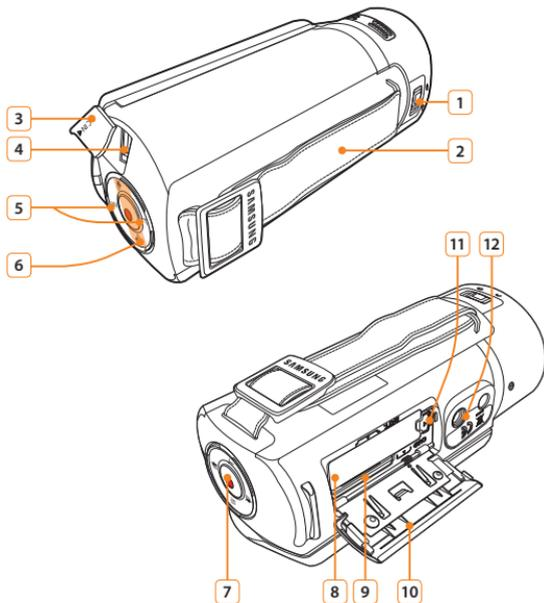
1 Переключатель открытия/закрытия объектива
