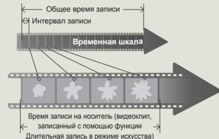
Функция Длительная запись в режиме искусства записывает фреймы изображений с предварительно заданным интервалом в течение всего времени записи. Это осуществляется для длительной записи видео. Функция Длительная запись в режиме искусства подходит для съемки следующих объектов:
