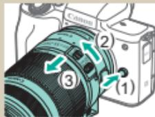
Снятие объективов EF и EF-S
