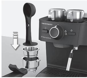
**5. Scegliere il filtro per una o due tazze,** piegare all'indietro la protezione per le dita e inserire il filtro nel braccetto portafiltro. Riempire il filtro con la miscela di caffè (un misurino per un espresso normale, due per un doppio espresso). Utilizzare l'altro lato del misurino per premere leggermente la miscela di caffè.
