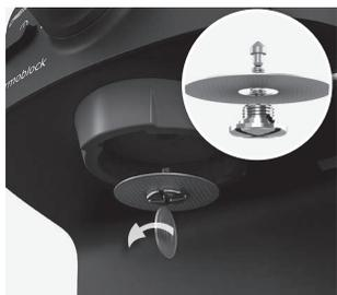
**1. Regelbunden avkalkning** rekommenderas, anpassat efter vattnets hårdhetsgrad. Avlägsna brygg huvudet (förvara delarna tillsammans) med ett mynt innan du fyller behållaren med vatten och avkalkningsmedel enligt produktens instruktioner.
