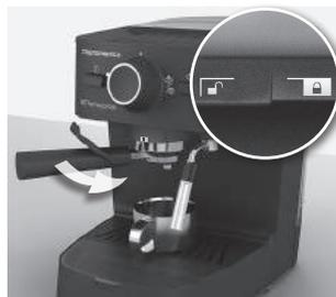
**6. Dle obrázku zasuňte držák filtru na místo.** Otočte držákem proti směru hodinových ručiček a utáhněte jej dle obrázku. Berte prosím na vědomí, že použití nadměrně silý zkracuje životnost součástí. Po dokončení zahřívání přesuňte otočný přepínač do polohy ☐. Káva začne vytekat výstupním otvorem – po dosažení požadovaného množství nastavte otočný přepínač do polohy ■.
