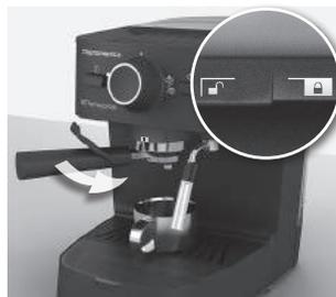
**6. Włóżć uchwyt filtra na swoje miejsce jak pokazano na rysunku.** Obrócić uchwyt w kierunku przeciwnym do ruchu wskazówek i dokręcić go jak pokazano na rysunku. Użycie zbyt dużej siły powoduje skrócenie żywotności elementów. Po zakończeniu podgrzewania ustaw pokrętło wyboru w położeniu ☐. Z wylotu kawy zacznie wypływać espresso – ustaw pokrętło w położeniu ■, kiedy uzyskasz żądaną ilość kawy.
