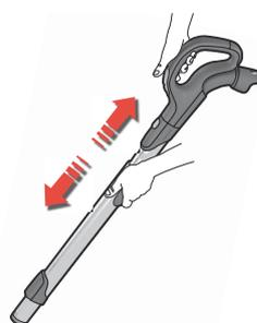
5. Отрегулируйте телескопическую трубку, держа замок одной рукой и вытягивая рукоятку другой.
