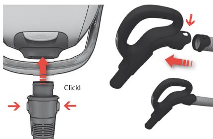
2. Вставьте шланг (чтобы снять его, нажмите кнопки замка и вытяните шланг).
