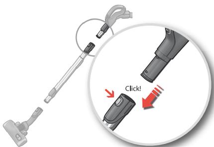
4. Присоедините телескопическую трубку к рукоятке шланга (чтобы снять ее, нажмите кнопку замка и вытяните рукоятку шланга).
