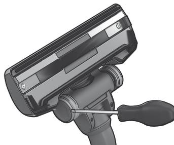
2. Если колеса застревают, очистите их, сняв крышки небольшой отверткой.
