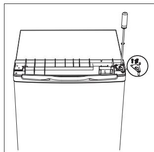
4. Отвинтите нижнюю петлю. Снимите регулируемые ножки с обеих сторон.
