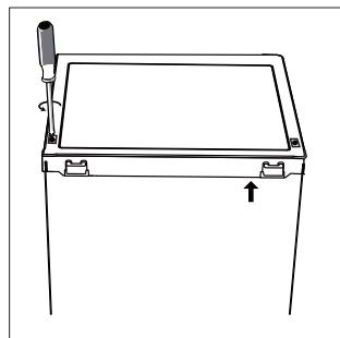
2. Снимите верхнюю крышку и ручку термостата, а затем уберите ее в сторону.
