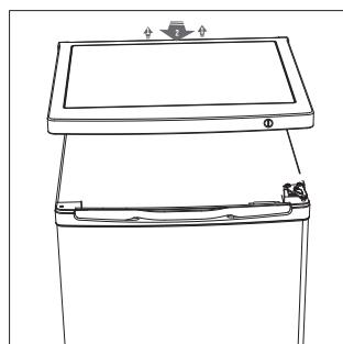
3. Отвинтите верхнюю петлю, затем снимите дверь и положите ее на мягкую поверхность, чтобы избежать царапин.
