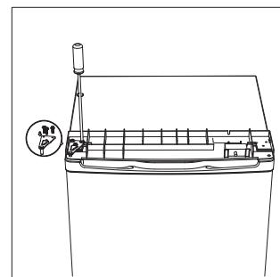
8. Встановіть верхню кришку і закріпіть її за допомогою 2-х гвинтів на задній частині.
