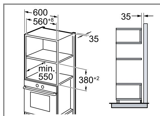
Прилад можна вбудовувати лише на тій висоті, на якій можна легко виймати з нього приладдя.
