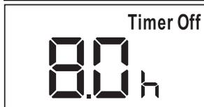
Таймер налаштований на вимкнення через 8 годин від поточного часу
