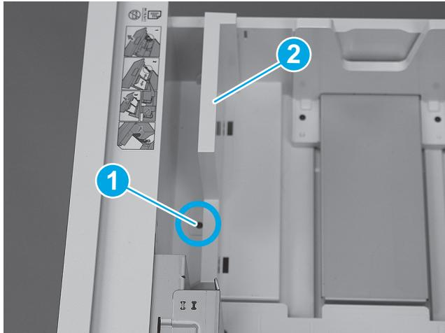
**RU** Открутите один винт (выноска 1), затем снимите левую переднюю направляющую (выноска 2).
