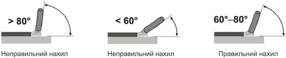
**Рисунок 4. Кут розташування електрода із покриттям до деталі під час ручного дугового зварювання («ММА»).**
