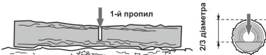
Рисунок 5. Схема попереднього розпи́лу колоди.
