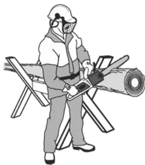
Рисунок 7. Схема розпилу колоди з використанням козлових опор.
