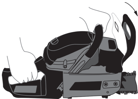
Рисунок 5. Схема роботи гальма ланцюга.
