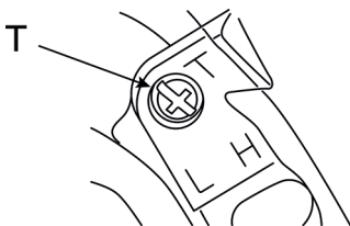
Рисунок 16. Схема розташування гвинтів регулювання холостого ходу.
