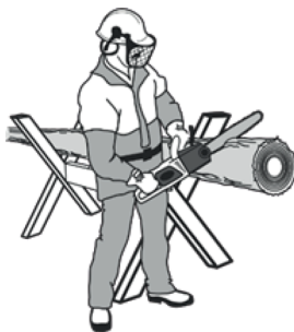
Рисунок 13. Схема розпи́лу колоди з ви́користанням козлових опор.
