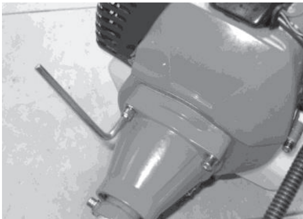
Рисунок 2. Схема приєднання стикувального вузла до двигуна виробу.
