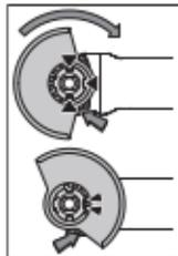
Помістіть захисний кожух (6) на кріплення на електроінструменті, поки кодовані кулачки на захисному кожусі не будуть збігатися з кріпленням. При цьому натисніть та утримуйте важіль розблокування (1).
