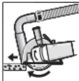
Увімкніть електроінструмент і приставте його передню частиною напрямних салазок до оброблюваної заготовки. Просувajte електроінструмент із помірною подачею у відповідності до оброблюваного матеріалу.
