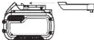
У режимі транспортування осередки електрично відключаються, утворюючи в результаті три акумулятора з більш низькою питомою потужністю в Втч в порівнянні з одним акумулятором з більш високою питомою потужністю в Втч. Збільшення кількості до 3-х акумуляторів зі зниженою питомою потужністю в Втч при перевезенні може звільнити
