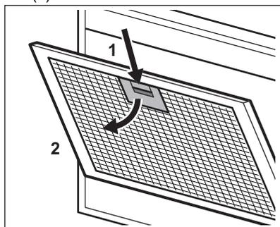
2. Incline ligeramente la parte delantera del filtro hacia abajo (2) y tire de él. Repita los dos primeros pasos para todos los filtros.
