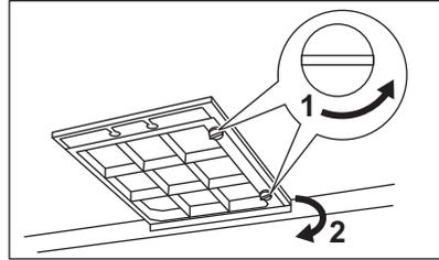
3. Utför proceduren i omvänd ordning när du ska installera ett filter.
