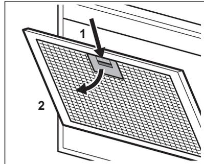
2. Kallutage filtri esiosa kergelt allapoole (2), seejärel tõmmake.
