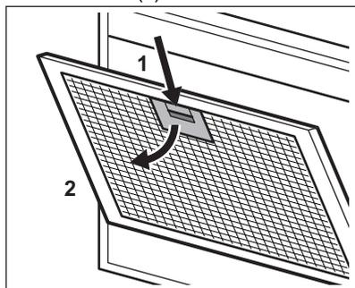
2. Немного наклоните переднюю часть фильтра вниз (2), а затем потяните.
