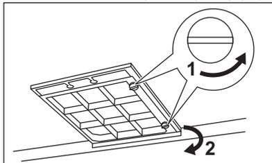
3. Při instalaci filtru proveďte stejný postup v opačném pořadí.
