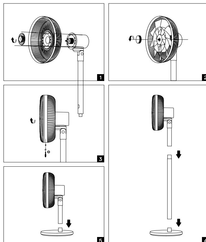
1. Сумістіть задню частину решітки з трьома виступами на головці вентилятора та затягніть кріпильну гайку задньої решітки, обертаючи гайку за годинниковою стрілкою.
