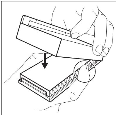
4. Вийміть верхню скляну поличку з холодильного відділення. Пусните пластиковий корпус із повітряним фільтром з лівого боку скляної полички.
