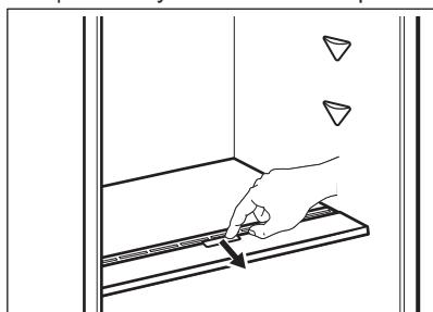
Щоб зняти прилад для регулювання вологості, відчиніть шухляду під скляною поличкою та зніміть кришку.
