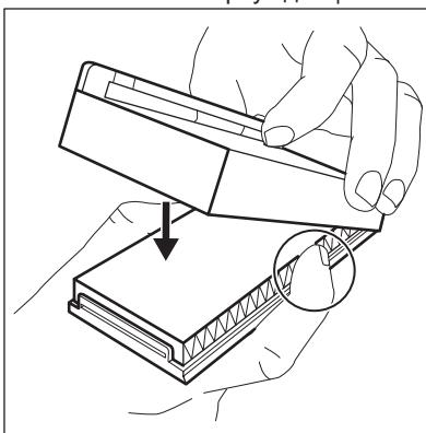
4. Извлеките верхнюю стеклянную полку из холодильного отделения. Сдвиньте пластиковый корпус с воздушным фильтром влево от стеклянной полки.
