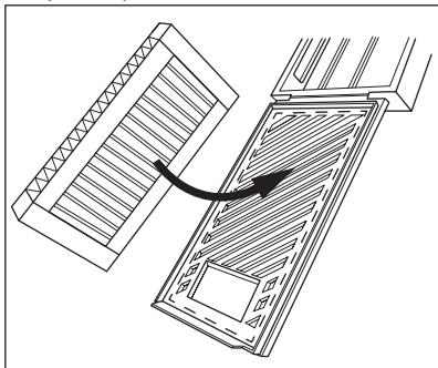
3. Утримуйте фільтр, закривши пластиковий корпус, доки не почуєте звук клацання.
