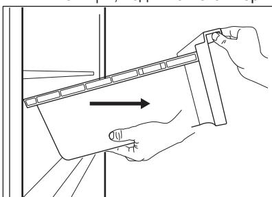
Чтобы снять стеклянную крышку GreenZone отделения:
