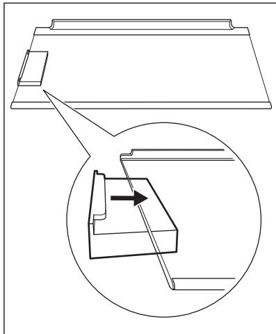
5. Вставьте стеклянную полку обратно в холодильное отделение. Будьте осторожны, чтобы не ударить фильтр при установке стеклянной полки.
