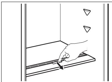
Чтобы снять устройство контроля влажности, откройте ящик под стеклянной полкой и вытяните крышку.
