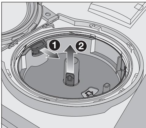
■ Розблокуйте тримач PowerDisk, потягнувши за жовтий отвір у напрямку стрілки 1, і одночасно потягніть тримач PowerDisk вгору за жовті поверхні для захоплення 2.
