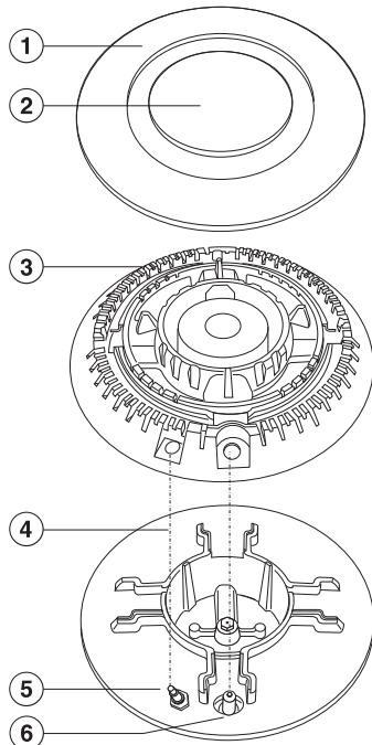
■ Вставте головку пальника ③ таким чином на основу ④, щоб термоелемент ⑤ і підпалювальний електрод ⑥ пройшли в отвір головки.
