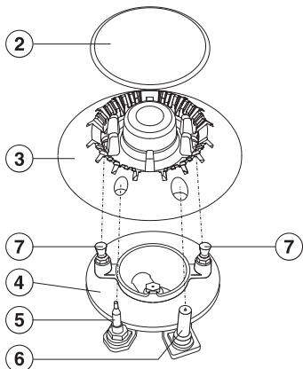
■ Вставте головку пальника ③ таким чином на основу ④, щоб термоелемент ⑤, підпалювальний електрод ⑥ і упорний шуруп ⑦ пройшли в отвір головки.
