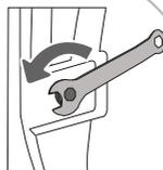
**1** Відсуньте шланги і за допомогою гайкового ключа ослабте 4 гвинти на задній панелі пральної машини, повернувши їх проти годинникової стрілки, як показано стрілкою. Ослабте їх приблизно на 30 мм (не повністю).
