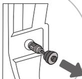
**3** Витягніть транспортувальні болти/гвинти разом з гумовою та пластиковою частинами.
