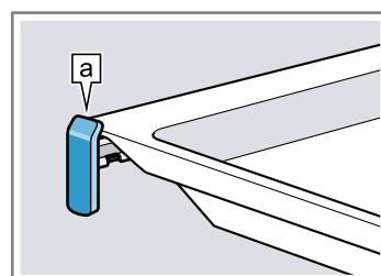
**Заметка:** В полностью выдвинутом положении направляющие фиксируются. Слегка нажмите на выдвижные направляющие при задвигании их обратно в рабочую камеру.
