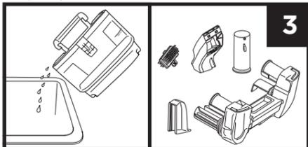
**3.** Вилейте брудну рідину з резервуара для брудної води, та очистіть його від будь-якого сміття. Очистіть ручні насадки, щітки, кришку та поплавковий клапан від будь-якого сміття. Ретельно промийте всі компоненти водою з милом і дайте йому повністю висохнути на повітрі перед повторним встановленням
