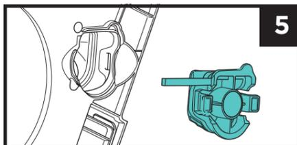
**5.** Щоб очистити будь-яке засмічення, зніміть з'єднувальний затискач у нижній частині пристрою. Очистіть усе сміття, потім закрийте кришку.
