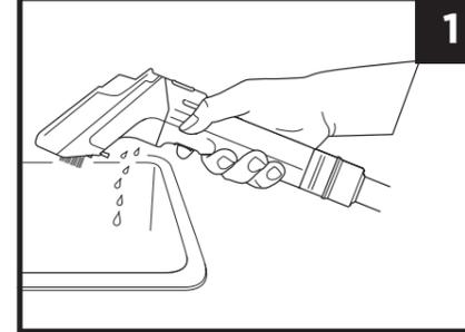
**1.** Від'єднайте пристрій від мережі та помістіть його біля раковини, унітазу чи каналізації, щоб злити з нього рідину. Очистіть пристрій і всі його частини (див. Технічне обслуговування та очищення шлангів).
