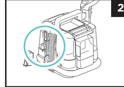
**2.** Коли очищення буде завершено і всі частини висохнуть, знову приєднайте всі інструменти. Оберніть шнур живлення навколо пристрою, та зберігайте інструмент для очищення шланга на пристрої. Оберніть шланг навколо основи пристрою та зберігайте ручний інструмент у його тримачі.
