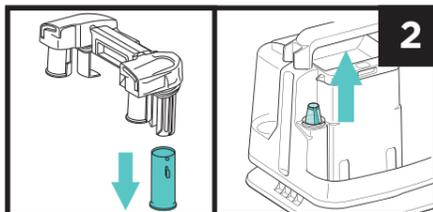
**2.** Очистіть поплавковий клапан і переконайтеся, що він може вільно рухатися всередині резервуара. Зніміть поролоновий фільтр із пристрою під час очищення резервуара.
