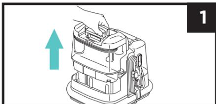
**1.** Від'єднайте резервуар для брудної води. Тримайте резервуар у вертикальному положенні та встановіть його на рівну стійку поверхню. Перемістіть ручку резервуара назад до упору, доки вона не клацне, а потім зніміть кришку.
