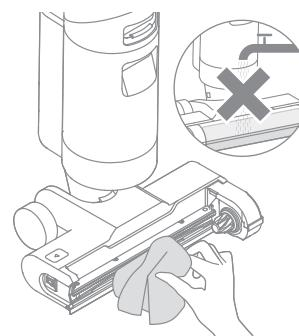
Предупреждение: Запрещается промывать установку роликовой щетки водой во избежание удара током или получения травм.
