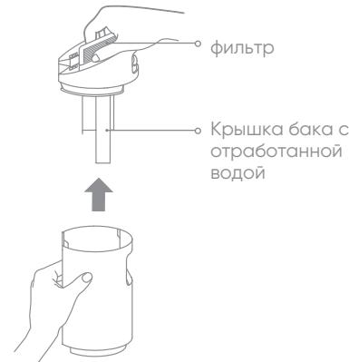
3. Ополосните бак с отработанной водой и крышку чистой водой. Очистите внутренние стенки бака с помощью чистящей щетки в комплекте.
