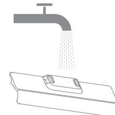
2. Кришку щітки можна промити чистою водою або протерти ганчіркою. Повністю висушіть деталі перед повторним використанням.
