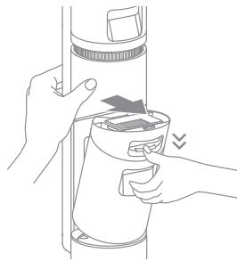
2. Извлеките фильтр из крышки бака с отработанной водой. Снимите крышку бака и вылейте отработанную воду.
