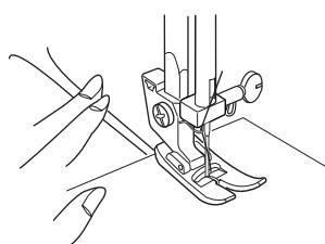
1 Поднимите прижимную лапку и расположите ткань в соответствии с направительными линиями на игольной пластине.
