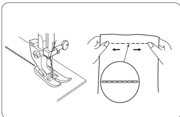
Этот прямой и прочный стежок рекомендуется использовать там, где для обеспечения комфорта и долговечности необходимы прочность и эластичность. Используйте его для усиления пройм и швов на брюках, а также на трикотажных и стречевых тканях, чтобы избежать сборок. Так же используйте его для обеспечения прочности, например, на рюкзаках.
