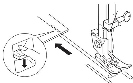
2 Для закрепления конца строчки нажмите на кнопку реверса и прострочите несколько обратных стежков. Поднимите прижимную лапку и снимите ткань, отведя нити назад.
