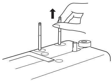
Катушечные стержни удерживают катушку с ниткой для подачи ее в машину. Чтобы воспользоваться катушечным стержнем, вытяните его наверх. Для хранения утопите вниз.
