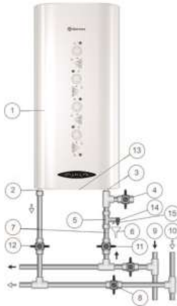
Рисунок 1. Схема підключення ЕВН до водопроводу в вертикальному положенні
