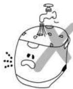
Запрещается мыть прибор водой. Не опускайте корпус мультиварки в воду или другие жидкости для очистки.
