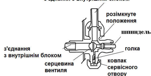
Схема трьохстороннього вентиля з'єднання з внутрішнім блоком
