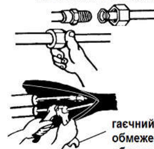
правильно неправильно додавання подовження до катаної труби
