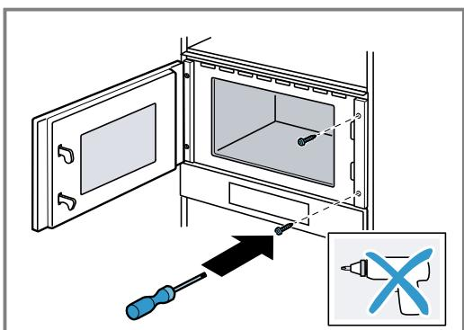
5. Просверлите отверстия для винтового крепления в стенке мебели со стороны петель.
