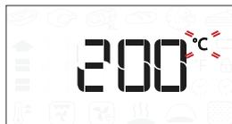
При мигающем значке «°C/°F» измените значение вращением ручки, а затем нажмите , чтобы подтвердить выбор и перейти к следующей настройке (при наличии). Одновременно вы можете задать мощность гриля (3 = высокая, 2 = средняя, 1 = низкая).
