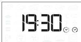
Примечание: Установка отложенного старта отменяет стадию предварительного прогрева духовки. Поскольку духовка выходит на заданную температуру постепенно,
