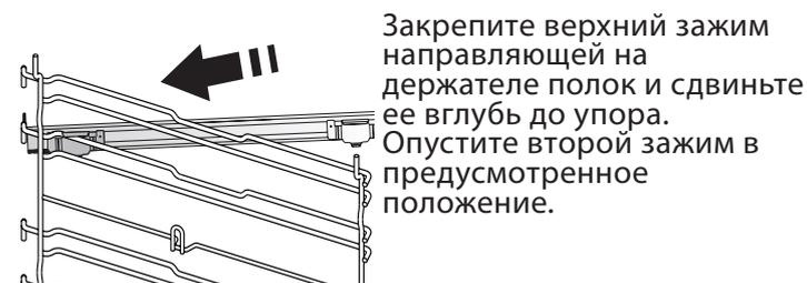
Чтобы закрепить держатель, с усилием нажмите на нижнюю часть зажима в направлении от держателя противня. Убедитесь, что подвижная часть направляющей может свободно перемещаться. Повторите эти же действия для второго держателя противня на том же уровне.
