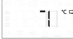
Якщо щуп для м'яса підключається під час вибору функції, дисплей відображає цільову температуру м'яса за умовчанням.
