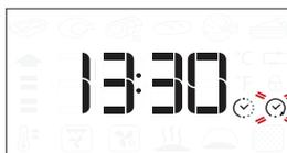
Вращая ручку, установите желаемое время окончания приготовления и нажмите , чтобы подтвердить значение и ввести в действие выбранный режим. Поместите продукт в духовой шкаф и закройте дверцу: Установка отложенного старта отменяет стадию предварительного прогрева печи.
