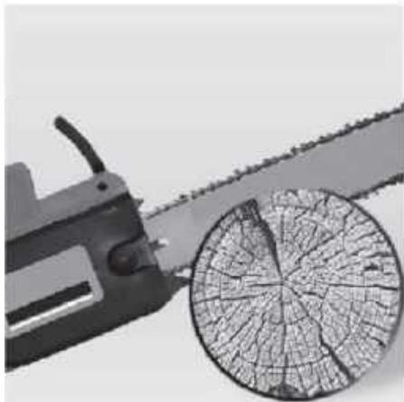
Не варто докладати зусиль під час різання деревини, власна вага пили дозволяє виконувати цей процес. Якщо ланцюг затиснуло, зупиніть двигун, підніміть дерево та витягніть ланцюг. Не варто тягнути інструмент, щоб витягнути пильну гарнітуру.
