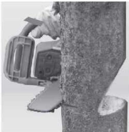
Виберіть направлення валки дерева. З того боку зробіть клиноподібний пропил висотою не більше 10 сантиметрів. Після чого зробіть горизонтальний проріз на протилежній стороні дерева. Не прорізайте дерево до кінця, залиште середину, це дозволить Вам керувати падінням дерева.
