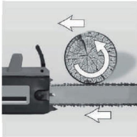
Можна розпочати різання знизу, для цього розріжте колоду на чверть діаметра, після чого закінчіть розпил зверху. Пам'ятайте, якщо колода не закріплена, то на початку розрізання вона може посунутись в сторону протилежну руху ланцюга та травмувати Вас.
